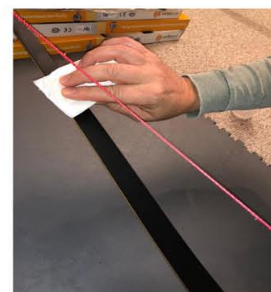
Klebestelle mit Aceton reinigen
